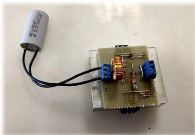
**Figura 6:** Circuito da bobina receptora montado
