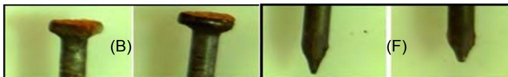
O resultado esperado era a presença de corrosão na amostra B e ausência na C, devido ao ambiente hidrofóbico no qual ele estava inserido, vide Figura 6.
