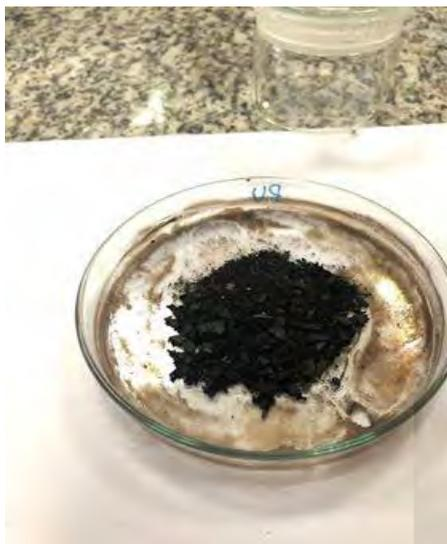
Para se obter as propriedades necessárias para a remoção do óleo da água, a substância, agora no estado sólido, foi misturada ao ácido oleico, incorporando, assim, uma camada apolar ao seu redor (figura 3).
