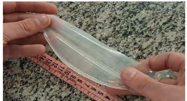
**Figura 4:** Foto do bioplástico obtido através do segundo experimento a partir apenas do amido de milho
