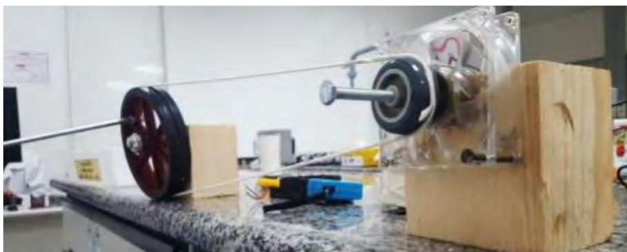
Figura 3 – Imagem ilustrativa do protótipo (teste piloto) para a avaliação com diferença de polias
