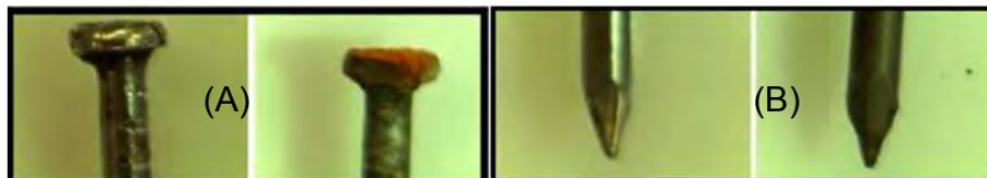
Portanto, a comparação entre essas duas condições sugere que o contato direto com a água acelera a oxidação do metal.
