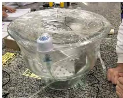
Para o teste de impacto, utilizou-se dois copos de vidro de mesmo peso, ml e marca. Em um desses copos, o material foi moldado a fim de envolver a amostra nas partes com maior sensibilidade, e no outro o papelão foi fixado da mesma forma (Figura 6). Para realizar o teste, os dois copos foram submetidos a uma queda livre de altura 165 cm.
