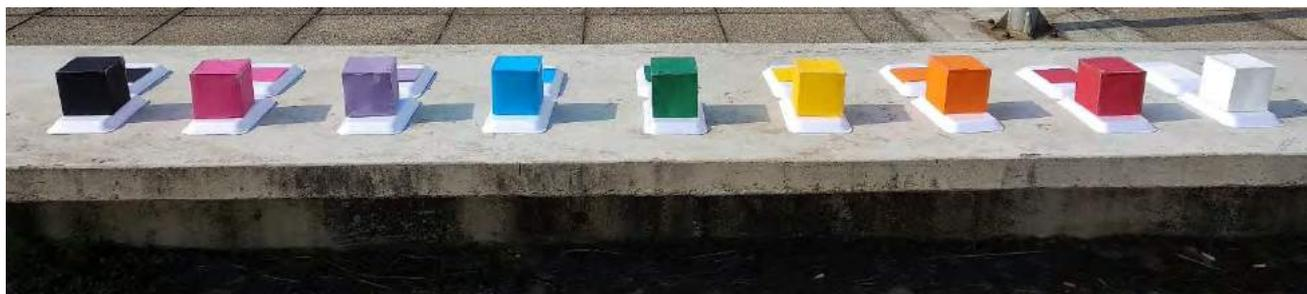
A cada cinco minutos, foram medidas as temperaturas internas de cada cubo, por meio de um termômetro de máxima e mínima (Incoterm®), e as das superfícies dos planos, por meio de um termômetro infravermelho (Benetech - GM 300), repetindo-se o processo por três vezes.
