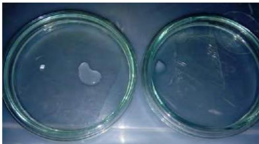
**Figura 1:** Amostra das películas de vidro e de plástico na solução alcalina (NaOH)
