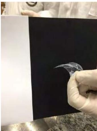
**Figura 3:** Película de vidro em estado de decomposição após reagir com o hidróxido de sódio (NaOH)
