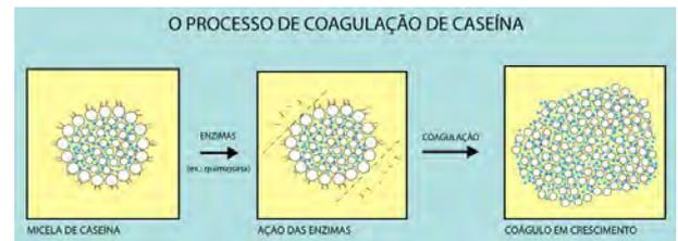
**Figura 6** - Coagulação das micelas de caseína pela ação enzimática.
