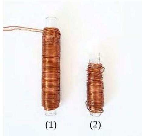
Todos os testes foram realizados com a fonte de corrente variável. As duas bobinas apresentaram um bom desempenho nos testes para sustentar o prego, no entanto foi verificado que na Bobina 2 o campo eletromagnético foi mais intenso do que na Bobina 1. Contudo, mesmo que na Bobina 2 a força aplicada no prego seja maior, na Bobina 1 o prego realizava um maior deslocamento, o que indicou a utilização desta para continuar o projeto.
