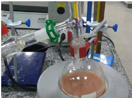
Na etapa da destilação do álcool, a temperatura deve ficar em torno de 78 °C, para que ocorresse apenas a sua evaporação e posteriormente condensação, por meio do resfriamento com água.
