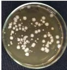
Em relação aos testes de desinfecção do efluente da Etapa 2, verificou-se que a concentração de 1 mg/L não foi eficaz para reduzir a carga bacteriana na amostra. Com as concentrações de 10 mg/L e 20 mg/L, não foi observado crescimento de bactérias no meio de cultivo indicando que estas concentrações foram eficazes no processo de desinfecção do efluente (Figura 5).
