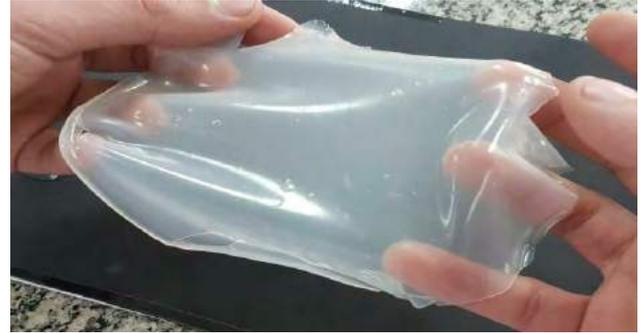
**Figura 2:** Foto do bioplástico obtido durante o primeiro experimento a partir do amido de milho com adição do ácido bórico a 5%
