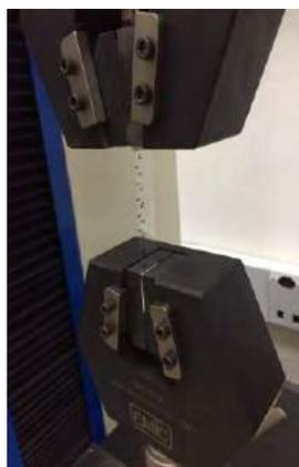
**Figura 2:** Máquina de tração utilizada para o experimento físico de tração.
