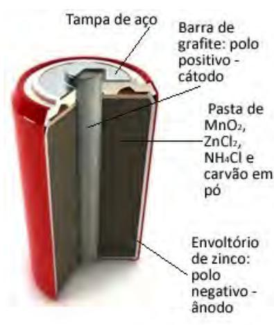
**Figura 1: esquema de uma pilha comercial
