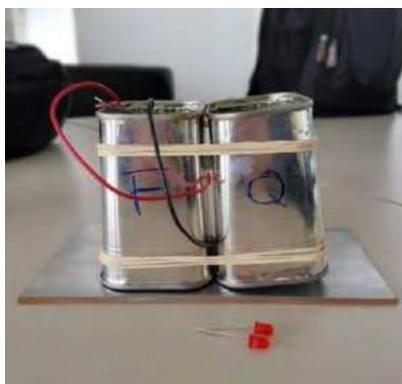
**Figura 1:** Estrutura finalizada para verificar o efeito *Seebeck*.
