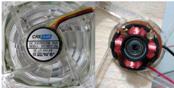
Figura 1 – Imagem ilustrativa da parte interna (comutador) do cooler ao remover o circuito de controle de rotação.
