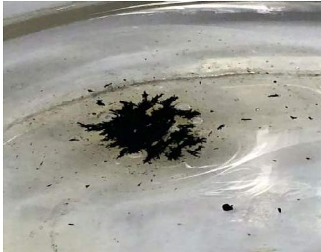
**Figura 5:** Comportamento do óleo com as nanopartículas incorporadas sobre a ação do ímã
