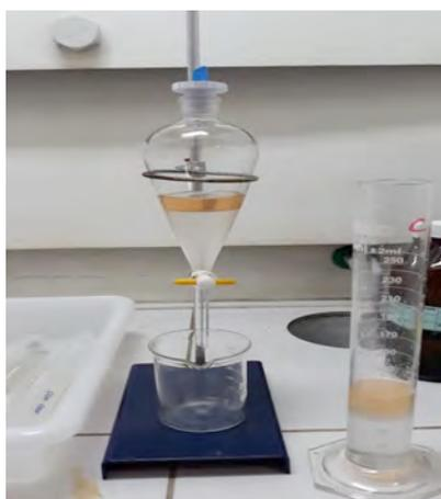
**Figura 3:** Separação da mistura com auxílio do funil de separação
