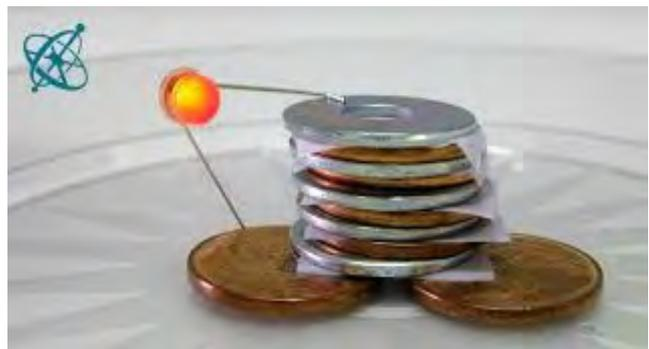
Figura 4: Esquema dos “sanduíches”
