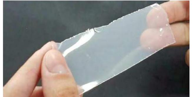
**Figura 3:** Foto do bioplástico obtido durante o primeiro experimento a partir do amido de milho com adição do ácido bórico a 10%
