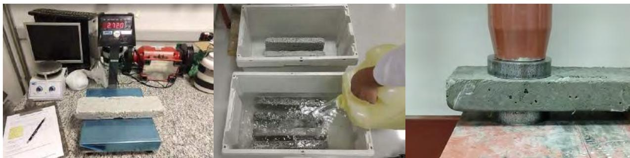
Figura 3: Pesagem, teste de absorção de água e resistência a compressão
