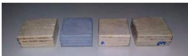
• **Placas de ferro:** nos testes com placas de ferro, buscou-se verificar a viabilidade dos impermeabilizantes na proteção contra a corrosão de metais, bem como a aderência do impermeabilizante em superfícies não-porosas. Foram usados quatro corpos de prova (cada um media: 3,4 x 3,1 cm): um não-revestido e os outros três revestidos (um com tinta Coral®, outro com impermeabilizante a base de diclorometano sem óleo e o último com impermeabilizante à base de acetato de etila com óleo) (Figura 4).
